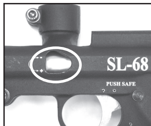
Figura 5: Limpieza de Ubicación del Puerto
