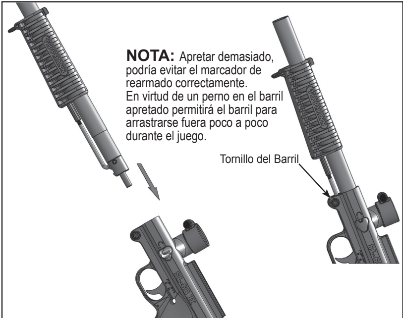
Figura 9: Inserte en el marcador Barril Ensamble corporal; Apriete Tornillo del Barril. El par recomendado: 50 lb-pulg.
